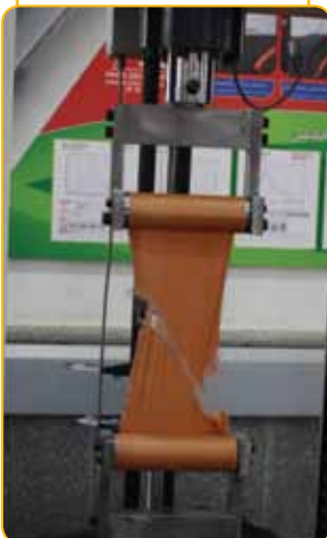
آزمایش کشش ژئوتکستایل با فک عریض غلطکی
